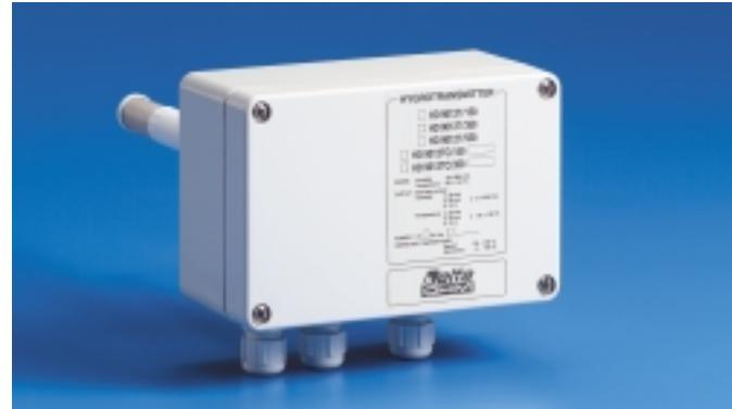
vertono l'umidità relativa e la temperatura da due sensori in due segnali analogici che possono essere a scelta 0-20 mA, 4-20 mA, 0-10 Vdc. Queste serie di trasmittitori sono attivi, cioè alimentati a 24 Vac o 240 Vac.
